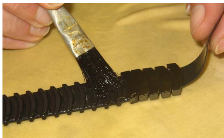
Sehne mit Silikonöl einpinseln, und Glieder auf Position ziehen.
